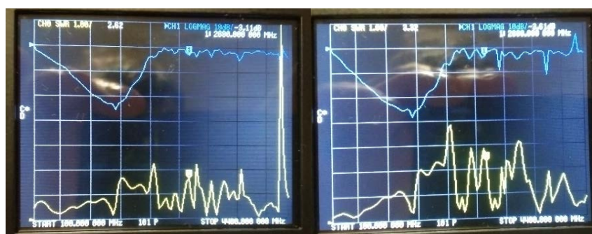
Рис. 6. Графики КСВ и ослабления МПЛ для 4 и 5 мм соответственно.
