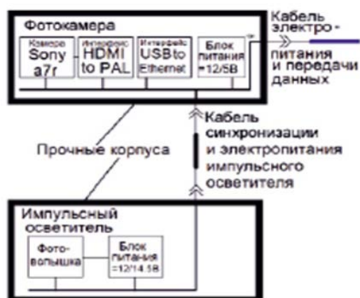
Рис. 1. Функциональная схема подводной фото и видео системы высокого разрешения
